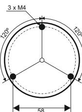
Закрепва се на планка с отвори 3 x Ø4мм с гайки и тампони (против вибрации), съдържащи се в комплекта
